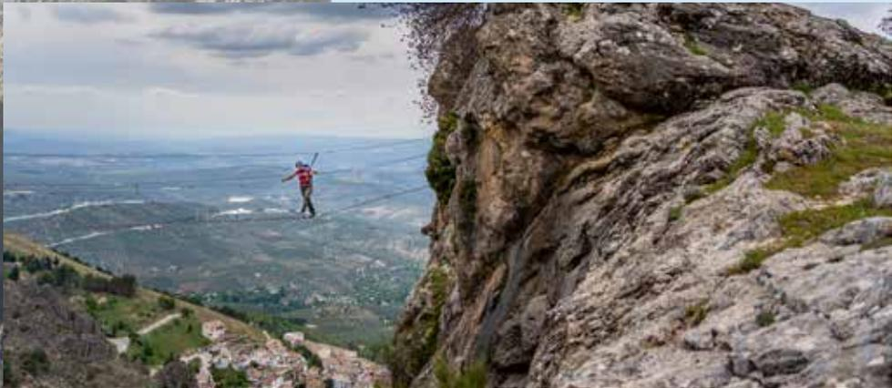
**16 ELEMENTO A DESTACAR:** Puente tibetano con dos cables en los pies, dos cables a la altura del pecho, uno a cada lado, y cosidos con el cable de abajo, y un tercer cable sobre la cabeza de seguridad. (40 metros).
